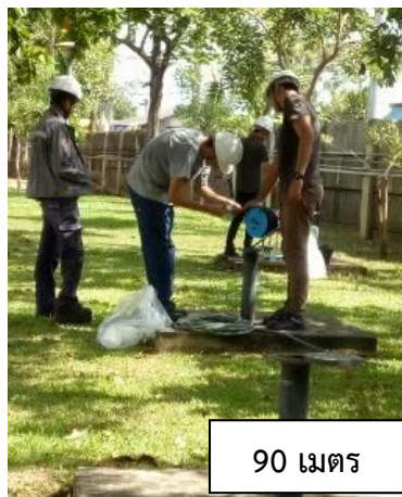
รูปที่ 4.13 การตรวจวัดระดับน้ำและเก็บตัวอย่างน้ำใต้ดินบ่อ ST01 ระดับความลึก 40, 90 และ 120 เมตร
