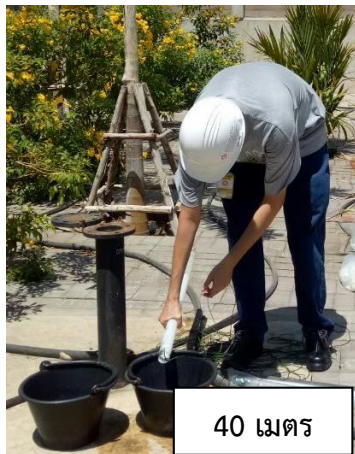
รูปที่ 4.14 การตรวจวัดระดับน้ำและเก็บตัวอย่างน้ำใต้ดินบ่อ ST02 ระดับความลึก 40, 90 และ 120 เมตร
