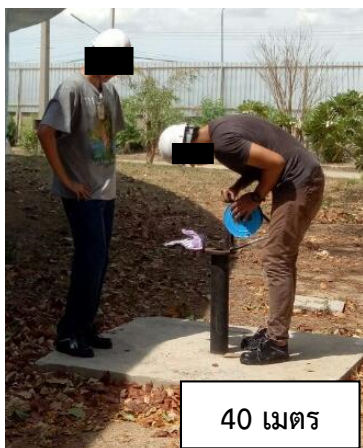
รูปที่ 4.15 การตรวจวัดระดับน้ำและเก็บตัวอย่างน้ำใต้ดินบ่อ ST03 ระดับความลึก 40, 90 และ 120 เมตร
