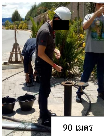
รูปที่ 4.14 การตรวจวัดระดับน้ำและเก็บตัวอย่างน้ำใต้ดินบ่อ ST02 ระดับความลึก 40, 90 และ 120 เมตร
