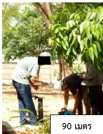
รูปที่ 4.15 การตรวจวัดระดับน้ำและเก็บตัวอย่างน้ำใต้ดินบ่อ ST03 ระดับความลึก 40, 90 และ 120 เมตร
