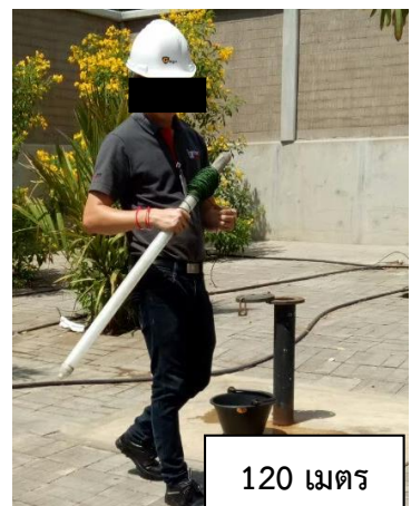
รูปที่ 4.14 การตรวจวัดระดับน้ำและเก็บตัวอย่างน้ำใต้ดินบ่อ ST02 ระดับความลึก 40, 90 และ 120 เมตร
