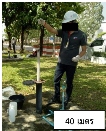
รูปที่ 4.13 การตรวจวัดระดับน้ำและเก็บตัวอย่างน้ำใต้ดินบ่อ ST01 ระดับความลึก 40, 90 และ 120 เมตร
