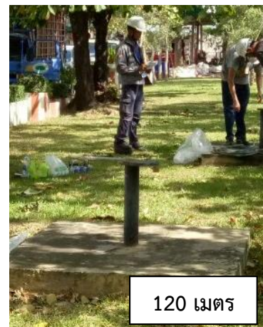
รูปที่ 4.13 การตรวจวัดระดับน้ำและเก็บตัวอย่างน้ำใต้ดินบ่อ ST01 ระดับความลึก 40, 90 และ 120 เมตร
